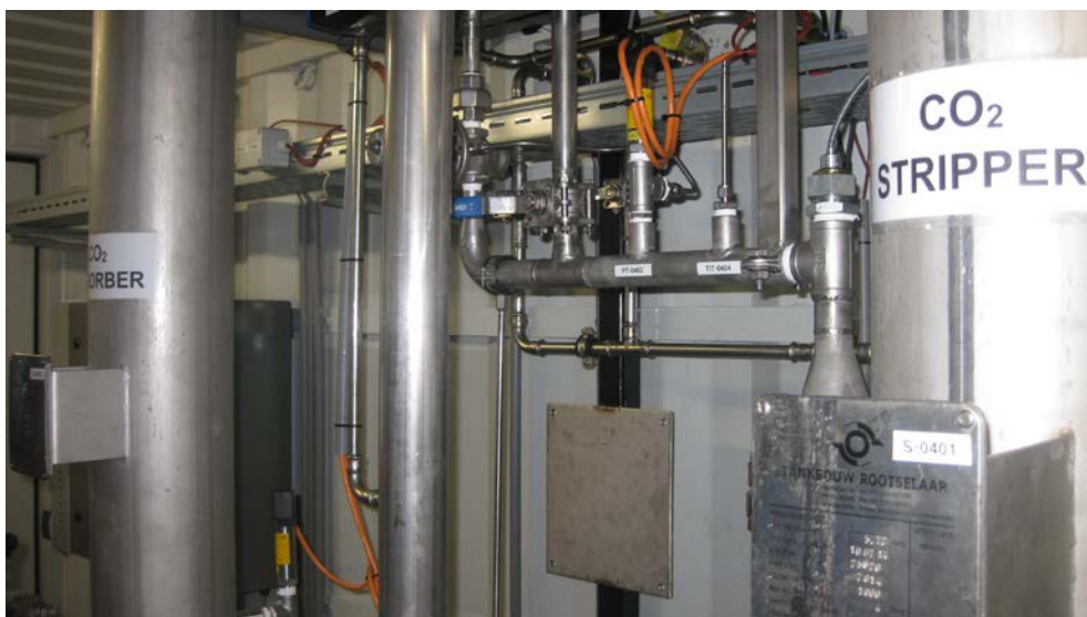
Binnen Biogas ETC is de bouw afgerond van een kleinschalige installatie voor het opwaarderen van biogas naar Groen Gas. In 2015 zal deze proefdraaien op WUR proefboerderij "De Marke".
